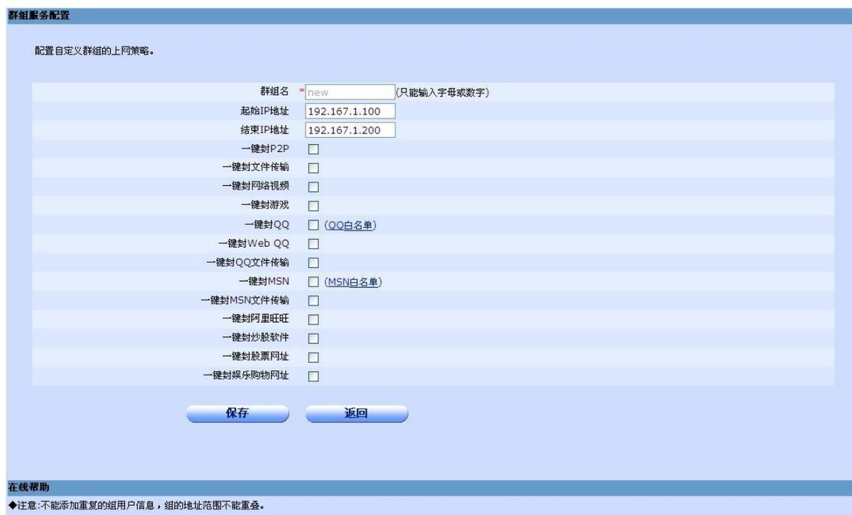
起始、结束 IP 地址：设定个性组的起始和结束 IP 地址。如果一个主机的 IP 地址在此范围内，在按照此个性组的配置生效。其他配置与全局配置中的含义相同。
