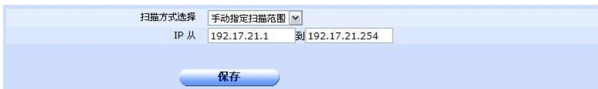
➤ 若选择了“禁止扫描并取消绑定”，则设备将不会扫描 ARP，而且原有的扫描结果也将自动删除（通过手动绑定添加的绑定将保留）。
