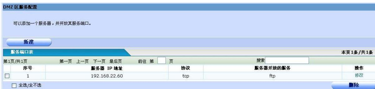
点击“新建”可以添加一个服务器。点击“修改”可以修改一个服务器配置。添加和修改页面如下：
