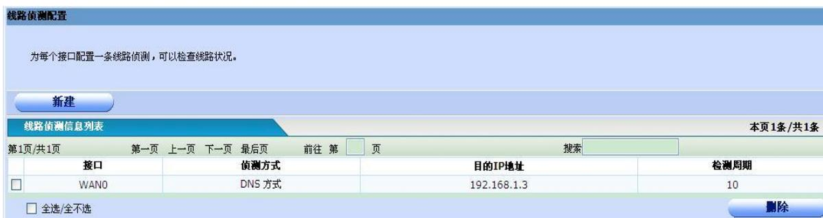
每个接口配置一条线路侦测，点击“新建”可以添加一条线路侦测。新建页面如下：
