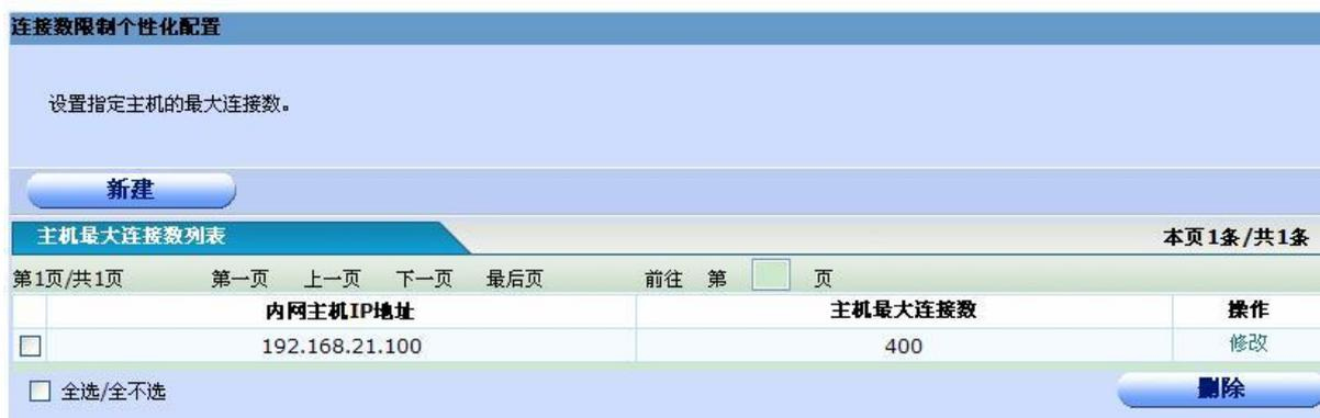
点击“新建”可以设置一个内网主机的最大连接数，点击“修改”可以修改一个内网主机的最大连接数，点击“删除”可以删除一个内网主机的最大连接数的个性化设置，此时主机的最大连接数将恢复到“连接数限制全局配置”中设置的最大连接数。
