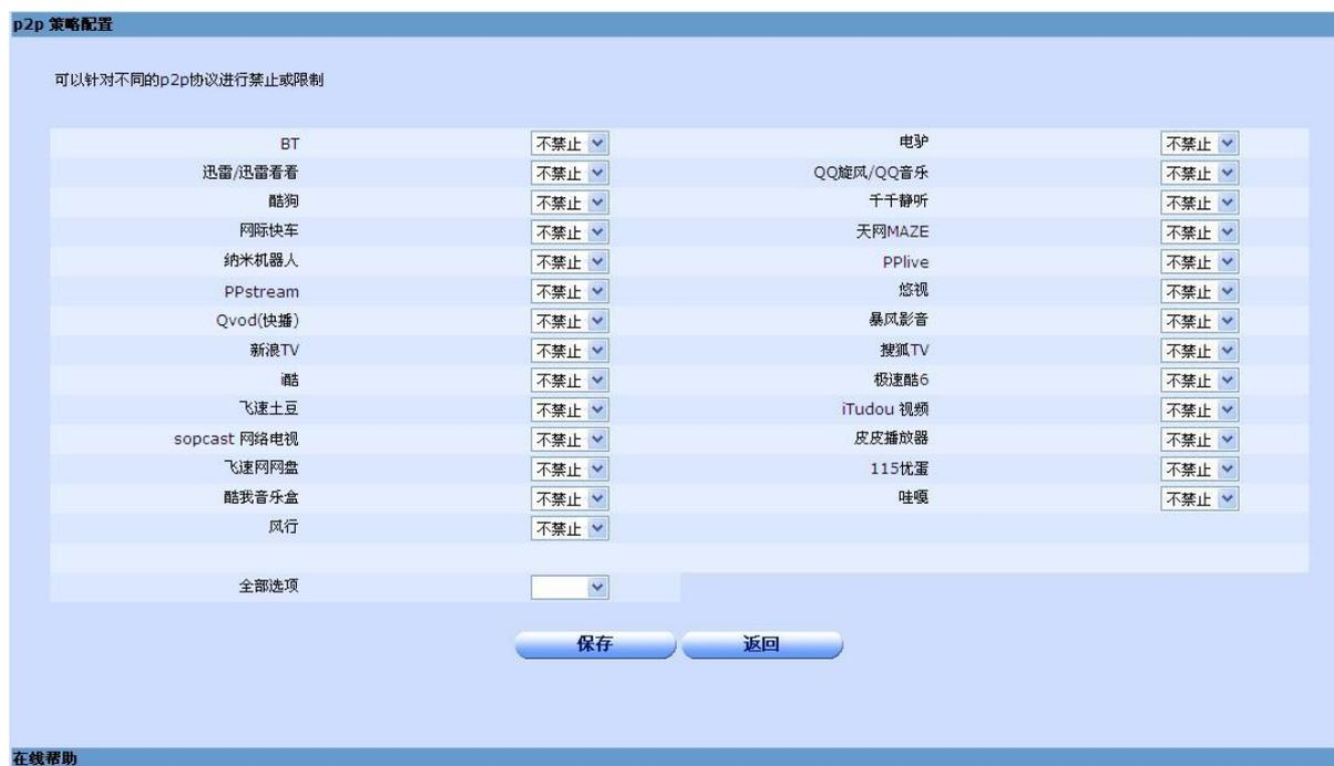
目前可识别的 p2p 协议包括 7 种下载工具和 10 种视频软件，每种协议可以选择不限制，限制或者禁止，如果选择禁止，则不能使用此 p2p 协议进行下载，值得注意的是，一般的下载软件都支持多种协议，例如迅雷支持 HTTP 分块传输、伪 IE 下载和 QQ 直播（QQLive）三种协议，因此要限制或者禁止某种 p2p 下载软件，最后把 http 分块传输和伪 IE 下载也选择相同的操作。
