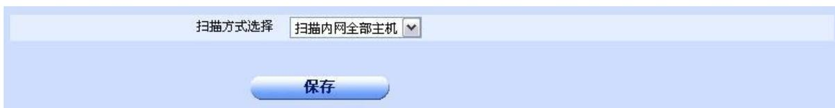
◆ **扫描方式选择**：可以选择“扫描内网全部主机”，“手动指定扫描范围”和“禁止扫描 ARP”。默认显示当前设备已使用的扫描方式。
