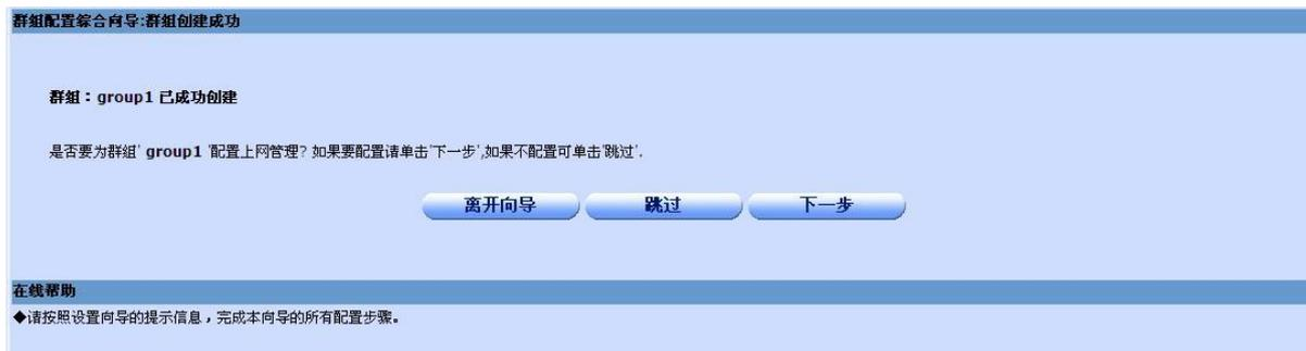
◆离开向导：单击“离开向导”，退出当前页面，返回“系统运行状态”页面。◆跳过：单击“跳过”按钮，将进入“QOS 策略配置确认”首面。◆下一步：单击“下一步”按钮，将进入“群组配置综合向导:配置上网管理群组策略”页面。
