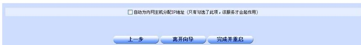
◆自动为内网主机分配 IP 地址：选中该选项表示设备在配置生效后，将通过 DHCP 的方式为内网需要获取 IP 地址的主机动态分配 IP 地址。
